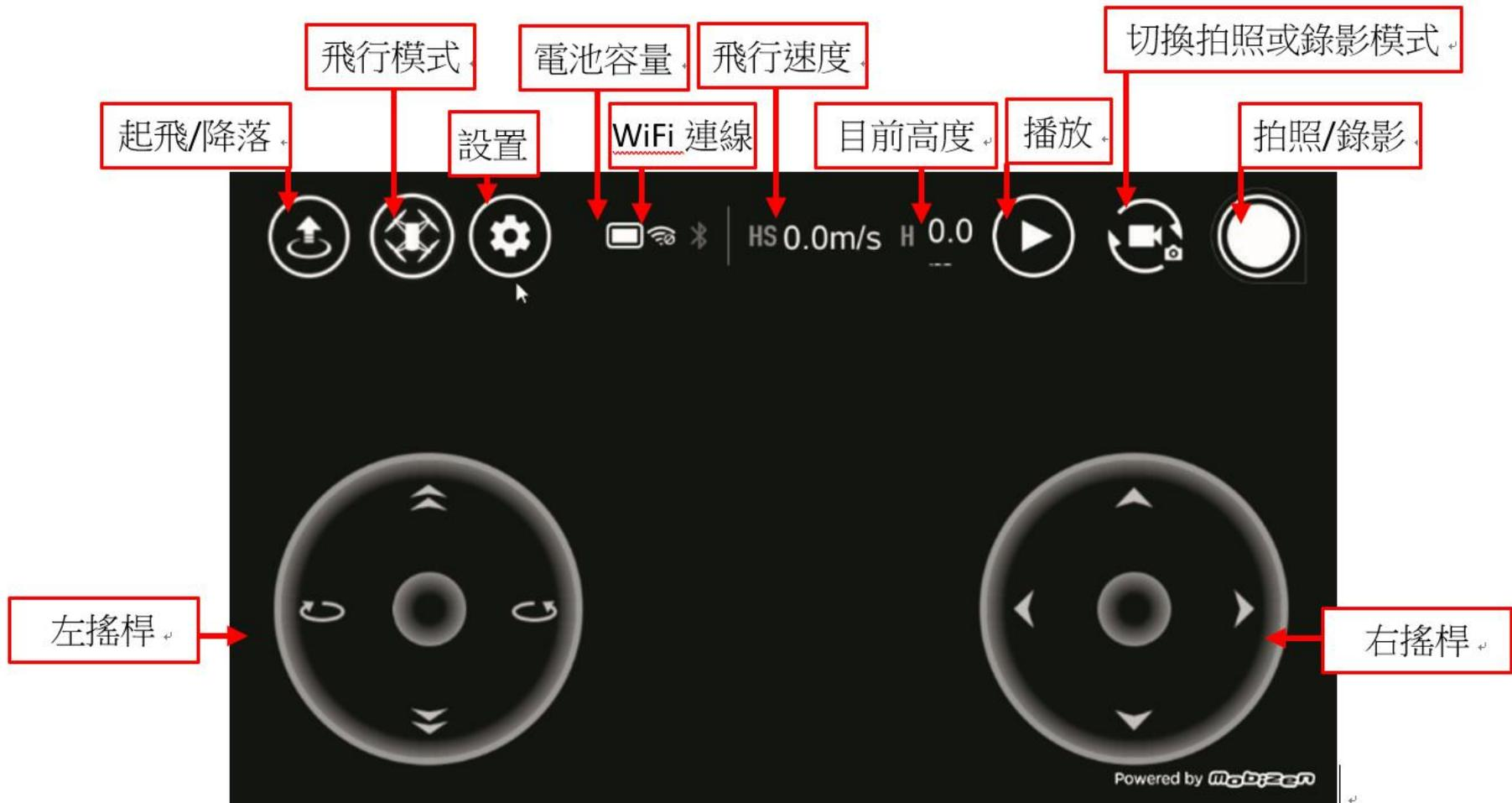
使用虛擬搖桿控制飛行 (預設操控方式為美國手)
